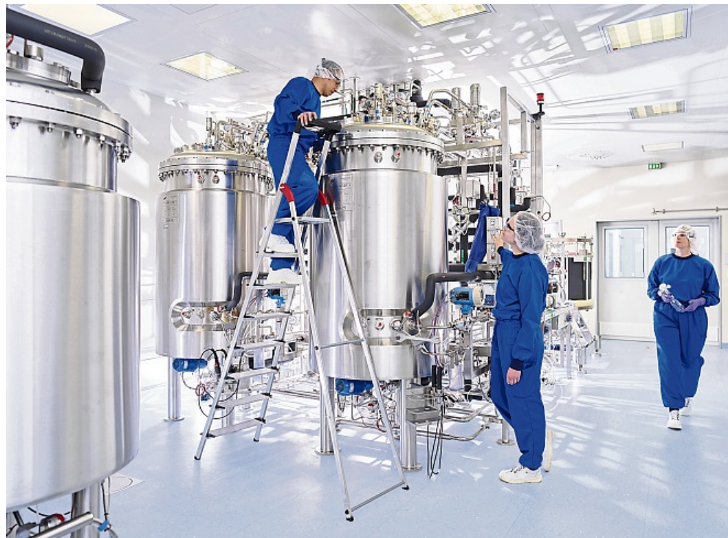
Voll gekapselte Fertigung: Hier arbeiten die Hamsterzellen bei mehr als 30 Grad. Sie haben den Bauplan für den jeweiligen Antikörper. JOHANNES RITTER, SIMONE HAUSLADEN/ROCHE (4)
